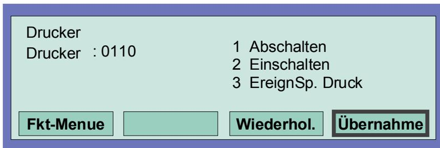
Abb. 95: Druckerfunktion, drucken des Ereignisspeichers
